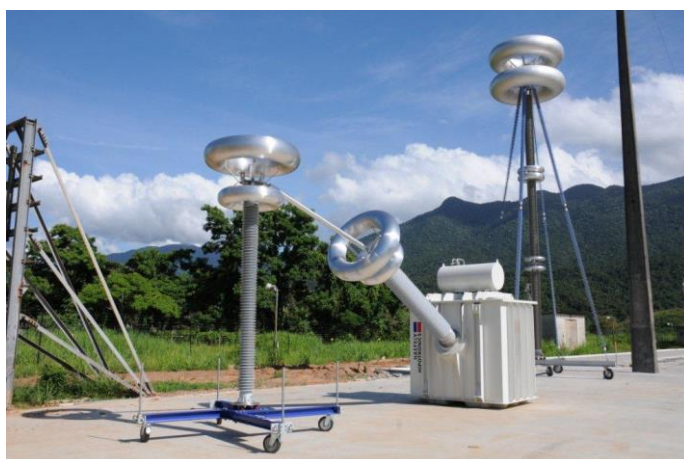
Foto 14 – Transformador de 500 kV e divisor de tensão (PSKO 500-500-60) Atividade nº 5 - UATCEF
